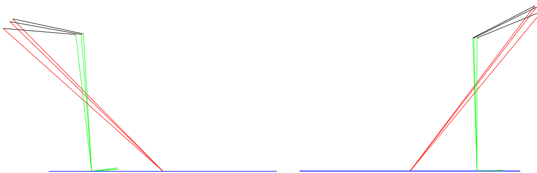
E.1 - Ilustrações da primeira e segunda fase com sinal da raiz quadrada invertido. À esquerda, a primeira fase de apoio duplo com sinal positivo adotado na Eq. (105); à direita, a segunda fase de apoio duplo com sinal negativo adotado na Eq. (105).
